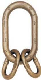
\* Carga de Ruptura es 5 veces la Carga Límite de Trabajo. Aplicaciones con cable de acero y eslingas sintéticas generalmente requieren un factor de diseño de 5. \*\*Carga de Prueba cumple o excede los requerimientos de ASTM A952(8.1) y ASME B30.9. ††Eslabón Maestro Soldado.
